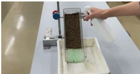
図1. 斜面崩壊モデル実験
