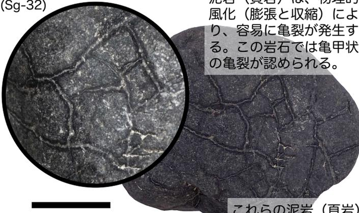
泥岩 (頁岩) は、物理的風化 (膨張と収縮) により、容易に亀裂が発生する。この岩石では亀甲状の亀裂が認められる。
