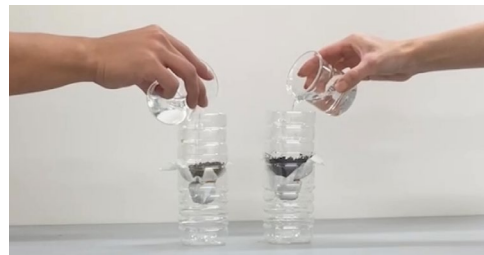
図2. 真砂土と腐葉土の保水性を確かめる実験
